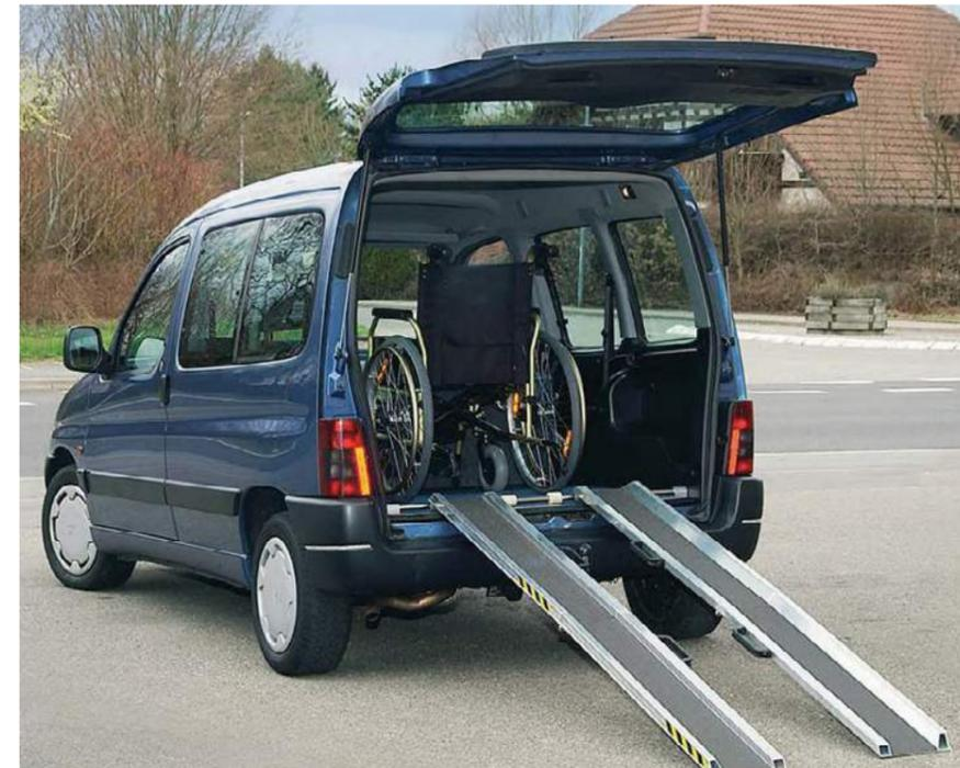
Die ALTEC-Auffahrliften RAS-W aus Aluminium sind ein sicheres und schnelles Hilfsmittel für Betreuer. Die Schienen laufen kugellagert auf einer rostfreien Stahlwelle, die fest im Fahrzeug montiert wird. Während der Fahrt sind die Schienen zusammengeklappt und werden stehend in einer Halterung gesichert. Die Fahrfläche ist mit einem rutschsicheren Korundbelag beschichtet.
